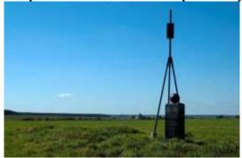
Геодезические пункты являются исходной основой при выполнении геодезических, картографических, кадастровых работ, при строительстве зданий, сооружений, наблюдении за их состоянием и высотными деформациями. Они могут быть расположены на земельных участках, на стенах и крышах зданий, в подвалах зданий, в устоях мостов и путепроводов, в основаниях памятников, на других искусственных сооружениях.
